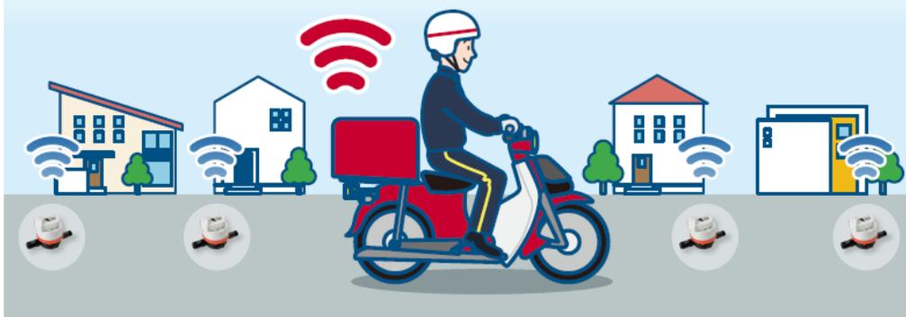
日本郵便の集配車両に検針機器を搭載し、集配ルートを走行することで、各戸に設置されたメーターから自動的に検針データが取得できる検針方法です。水道検針業務の人手不足解消が期待されます。
